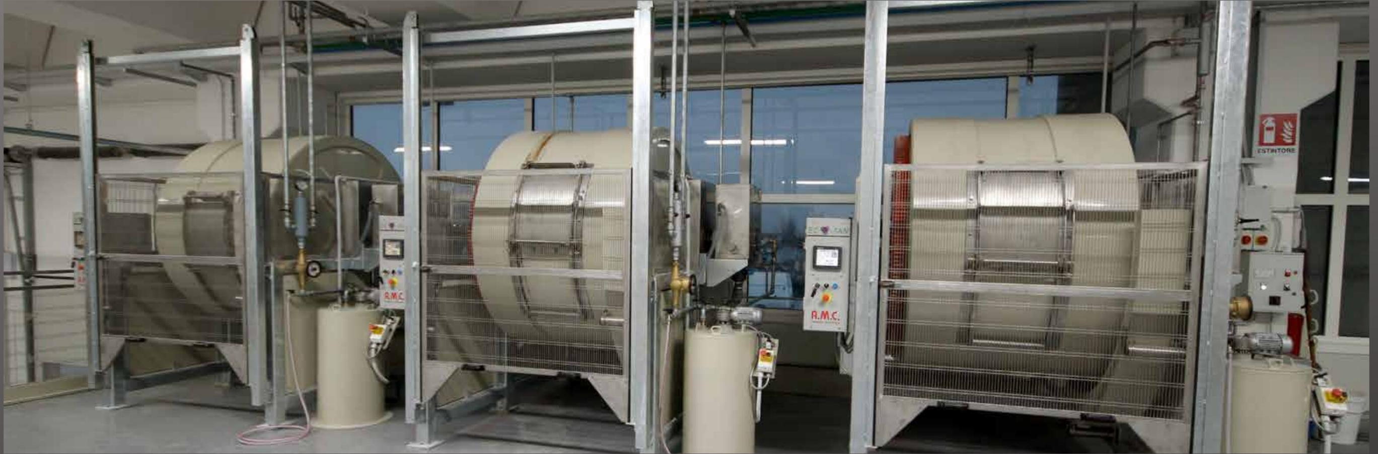
SOPRA E SOTTO ALCUNE VISTE DI BOTTALINI IN POLIPROPILENE COMPLETI DI BASAMENTO IN ACCIAIO, CANALA DI SCARICO, BIDI-
